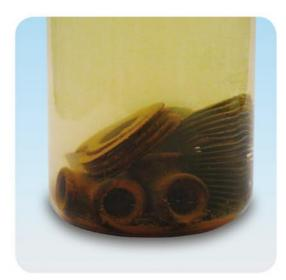
PARTICOLARE DI RACCORDI VARI IMMERSI IN ACQUA DI RETE NON PROTETTA.
